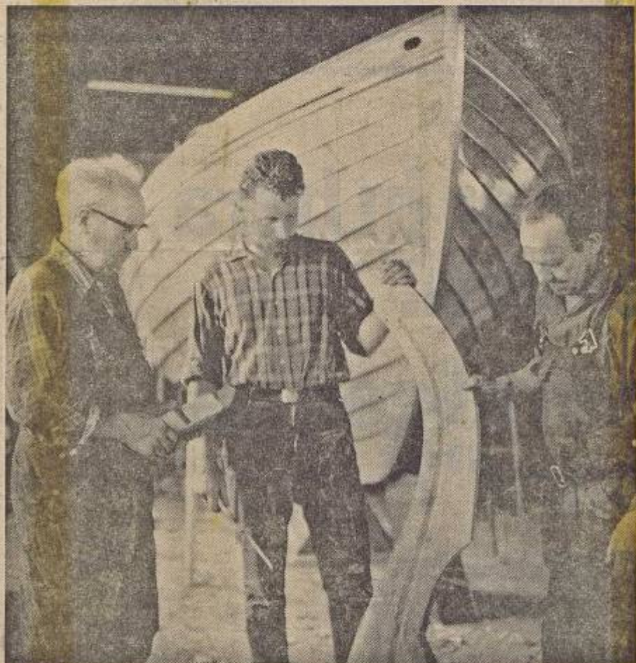
Bröderna Ivar och Gösta Westin flankerar här Claes-Göran Rampeltin som håller på med ett akterstycke. I bakgrunden står den snart leveransklara högsjöbåten, som skall gå till Västervik.
