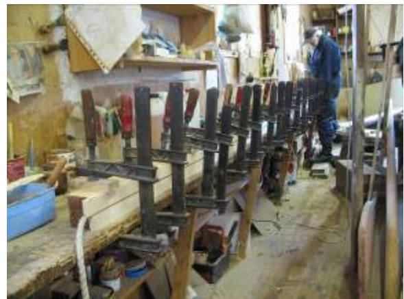
Med repet drog vi bort lim ur likrännan i den nytillverkade bommen.
