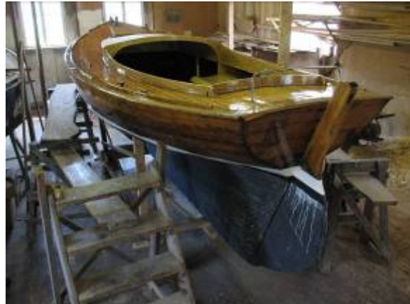
Sju lager fernissa och målad vit vattenlinje. Botten ska bli svart.
