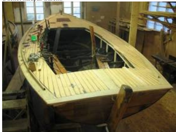
"Nabben II" strippad på ombyggnader och vi räddar originaldäcket.
