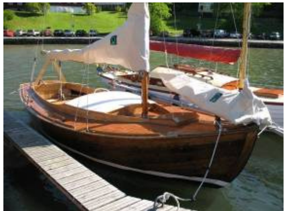
Det tog ett par veckor för båten att gå ihop och bli tät.
